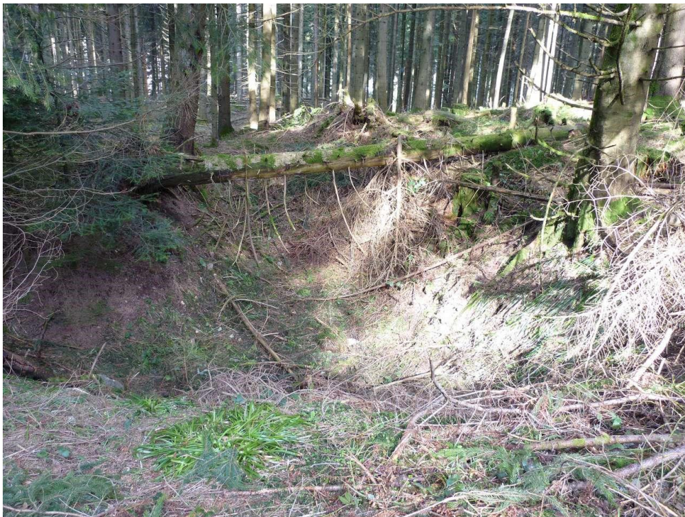
Photo 16 : Désordre D4 de type fontis au droit de la galerie supérieure de la Mine Noire G8
