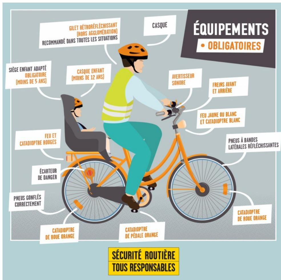
L'absence de l'un de ces équipements est une infraction au Code de la route pouvant être verbalisée par les forces de l'ordre en cas de contrôle routier.
