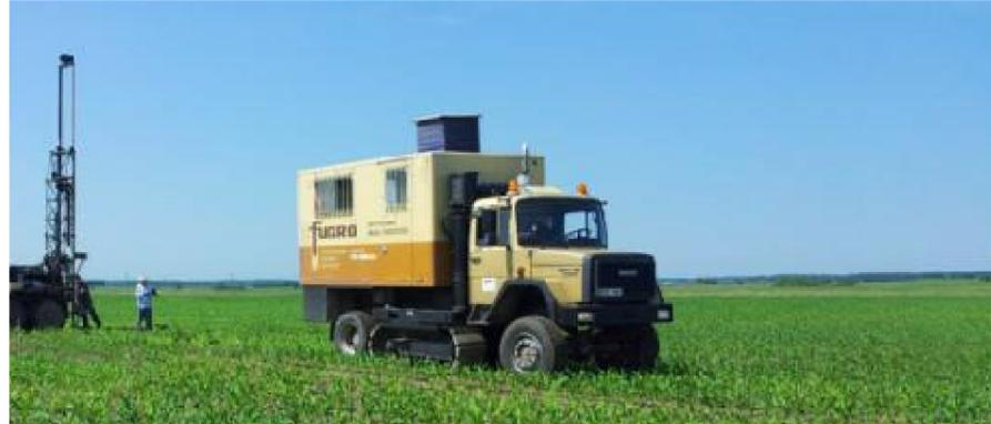
Engin permettant la réalisation de sondages au pénétromètre statique type CPT
