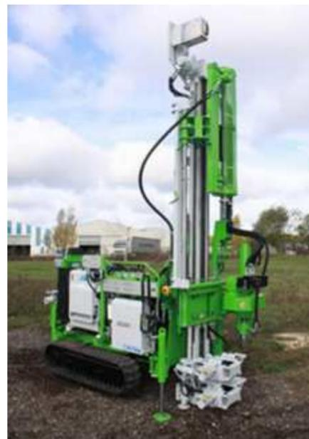
Engin permettant la réalisation d'essais pressiométriques et de sondages carottés (carottier).
